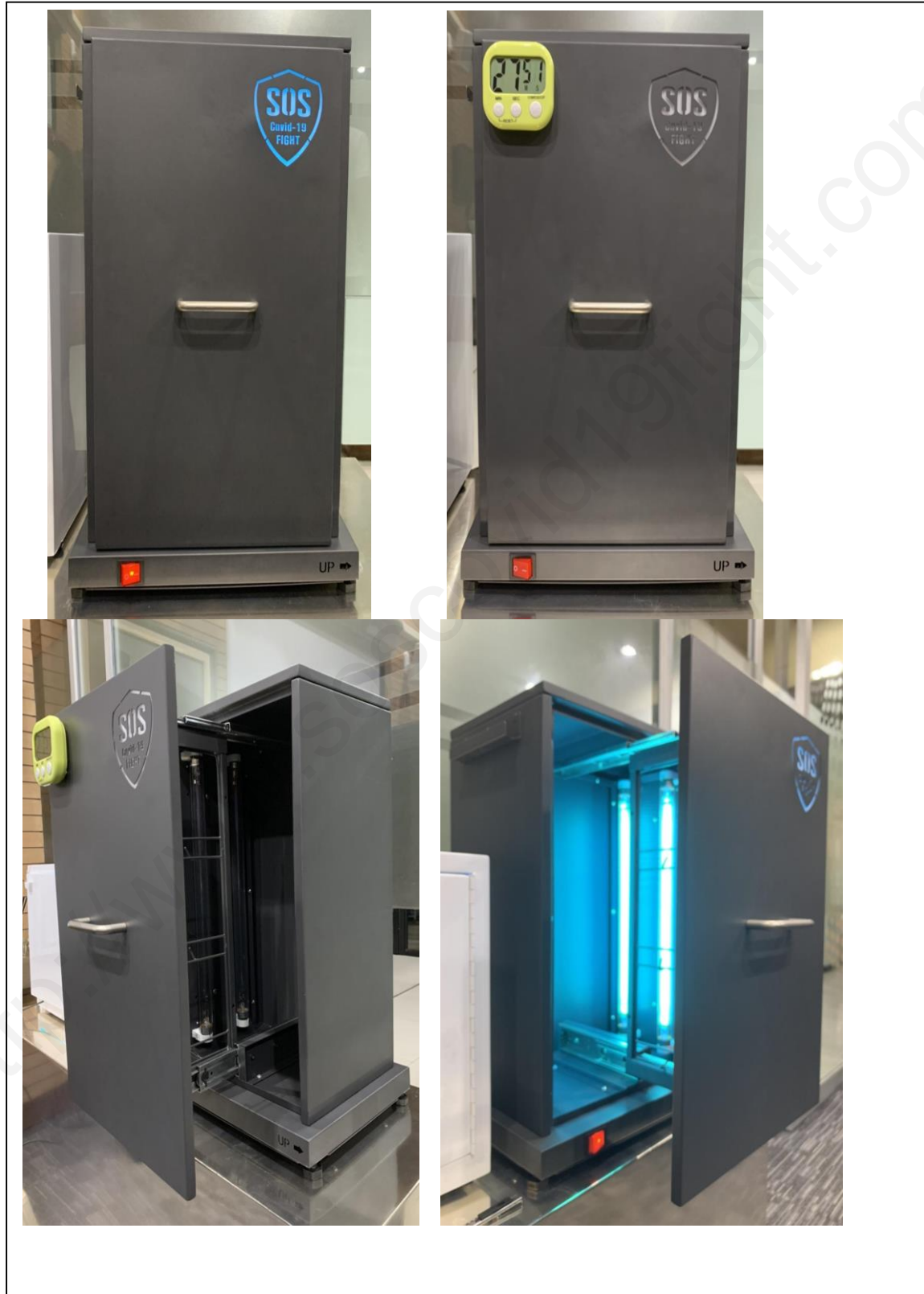
ภาพที่ 20 แสดงตู้อบฆ่าเชื้อด้วยแสงอัลตราไวโอเลตชนิด C ที่ออกแบบขึ้นมาใหม่ แบบตู้เดี่ยว
